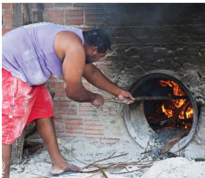
Figura 9. Fomalha para gerar calor para a torração da farinha de batata-doce.
