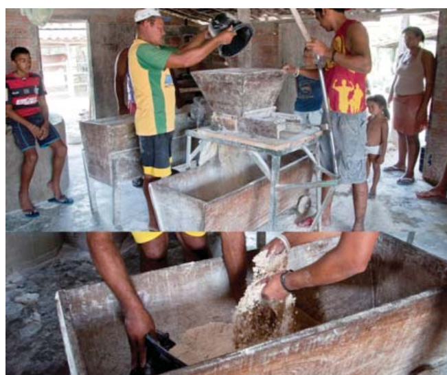
Figura 7. Ralação da massa prensada.
